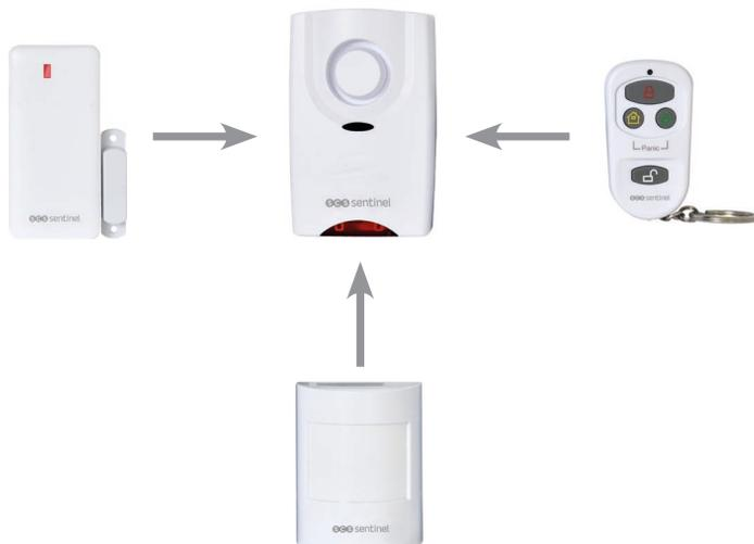
La sirena principal tiene 2 funciones : control y recepción. Por defecto los sensores están programados y conectados a la sirena principal. No se necesita ningún arreglo. Si uno de los sensores (apertura o movimiento) detecta una intrusión, la sirena principal activa una alarma ruidosa (100 dB) y parpadea en rojo. El control remoto permite activar o desactivar la sirena principal.
