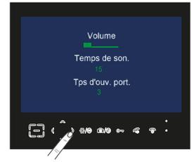
Appuyer à gauche ou à droite pour ajuster le volume, la durée de la sonnerie (1-15 secondes) & le temps d'ouverture (1-9 secondes). Puis appuyer sur
