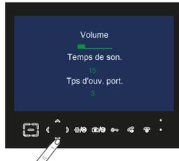
Appuyer sur les flèches pour choisir le volume, la durée de la sonnerie & le temps d'ouverture du portail. Puis appuyer sur
