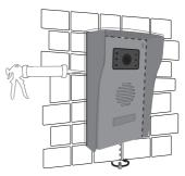
Après installation et test, placer un joint silicone transparent sans acide sur le haut et les côtés de la platine de rue (pas sur le bas) pour éviter tout risque d'infiltration.
